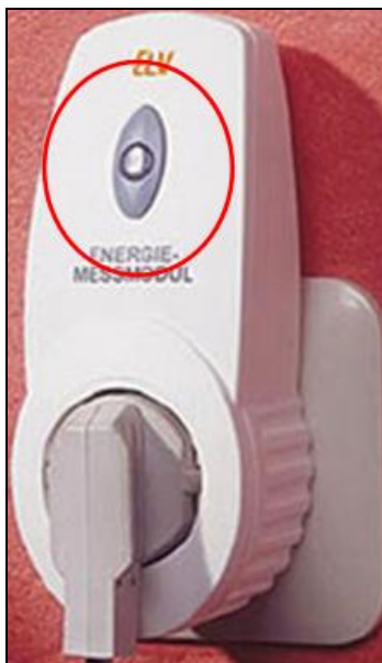
Abb. 16: Taste und Kontrollleuchte der Messsteckdose
