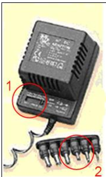
Abbildung 14: Netzteil mit Schiebeschalter (1) und Steckeradaptern (2)
