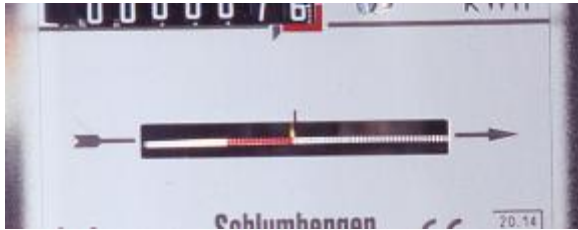
Abb. 2: Drehscheibe eines typischen Stromzählers mit roter Markierung
